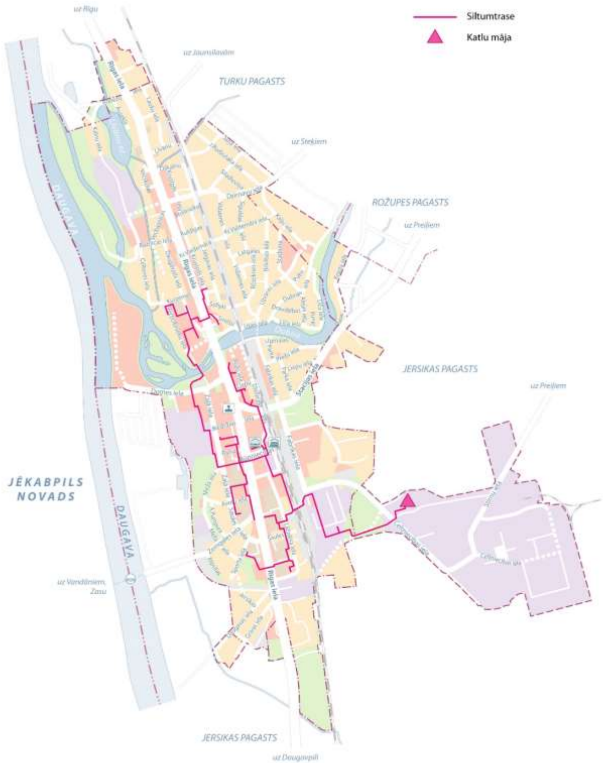
1.5. att. Centralizētās siltumapgādes sistēma Līvānu pilsētā
